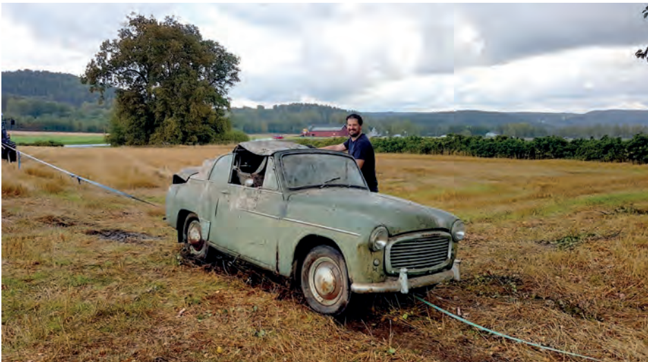
Entusiastisk ny eigar med sin Hillman. Bremsespora viser at det aldri er ein god ide å langtidsparkere med handbremsen tiltrekt.
